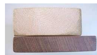
レッドシーダー材(上)とイペ材(下)の断面。イペは水に沈むほど緻密で硬い。
